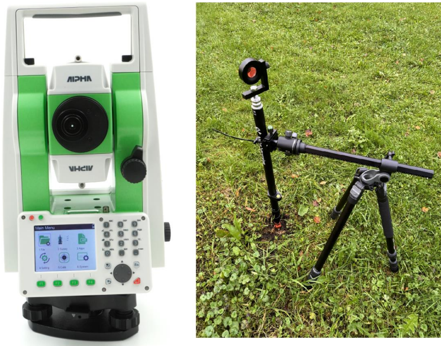
Kuva 4. Alpha Ti- takymetri ja referenssipisteiden mittaus prismalla.
