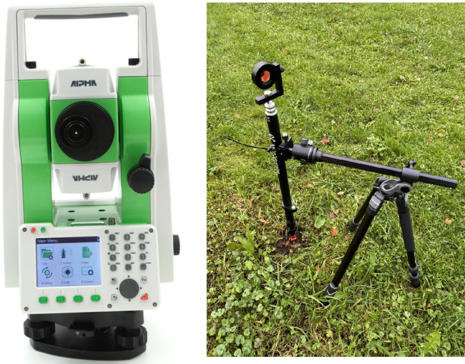
Kuva 4. Alpha Ti- takymetri ja referenssipisteiden mittaus prismalla.
