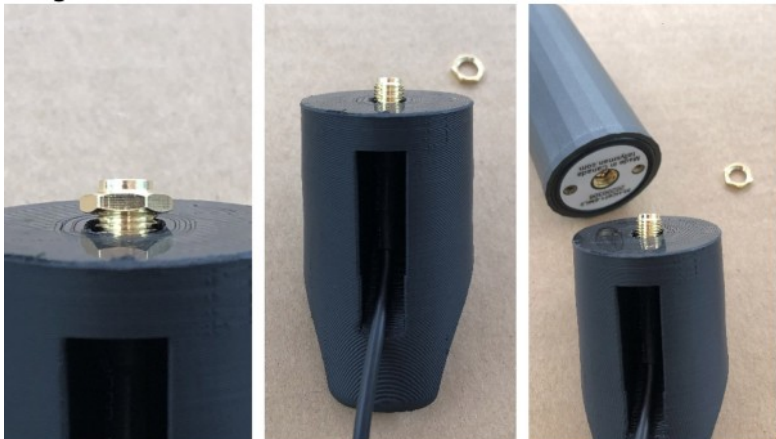
Kuva: Irroitettu mutteri ennen antennin asennusta.
